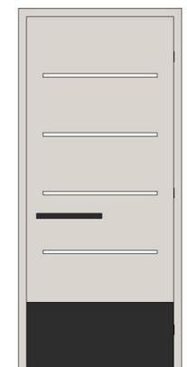
Figura 29 - Vista frontal da porta para PCD (0,80x2,10m).
